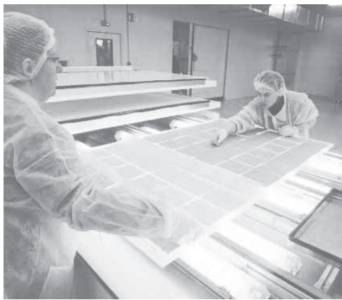
Unité de montage de panneaux photovoltaïques
